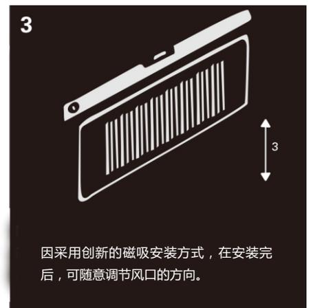
因采用创新的磁吸安装方式，在安装完后，可随意调节风口的方向。
